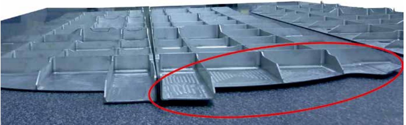
1 Die Abweichungen auf der rechten Seite des Werkstücks sind deutlich erkennbar und betragen mehrere Millimeter (© Matzat)
